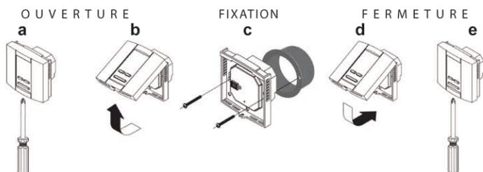
**d et e** : **Précaution de manipulation** : pour refermer le thermostat, vous ne devez sentir aucune résistance. Une mauvaise manipulation peut déformer les broches de contact ce qui annulerait la garantie.
